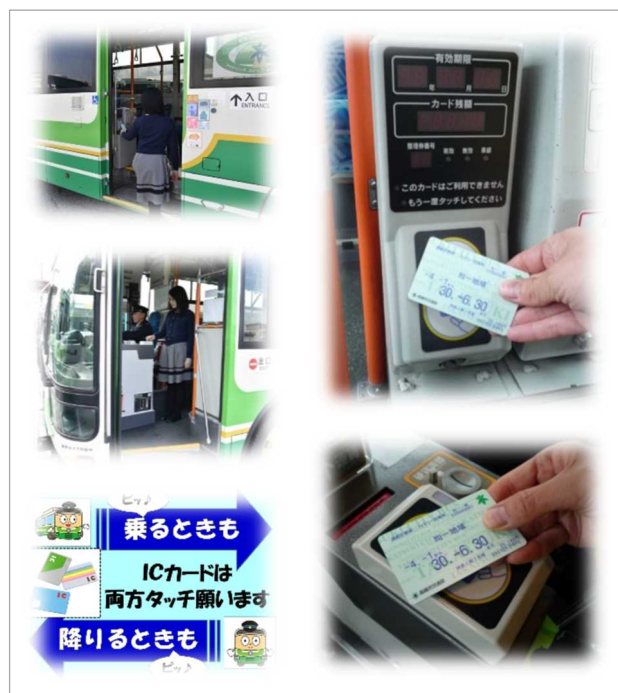
図 2-4-3 IC カードの 2 タッチ方式
