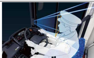
乗客員の顔見守り・運転士の検知を妨げない位置にカメラを設置
