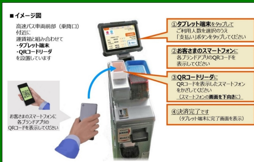
図 次世代型運賃箱（クレカ・QRコード等によるタッチ決済対応）
