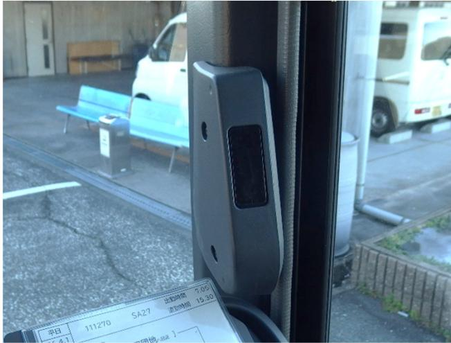
ドライバーステータスマニター(DSM)専用カメラ
